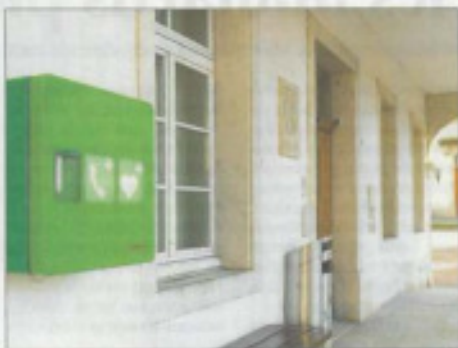
Ce coffre ne contient pas qu'un défibrillateur mais un dispositif connecté directement avec la centrale 144 et localisé par GPS.
